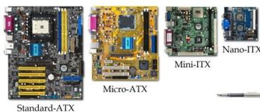
Форм факторы современных материнских плат – стандарт, который определяет размер платы, места, где она закреплена на корпусе, также интерфейсы подключения различных комплектующих и прочих периферийных устройств. Тип подключения процессора, сколько слотов для оперативной памяти, видеокарты и прочих устройств – зависит от форм фактора.
